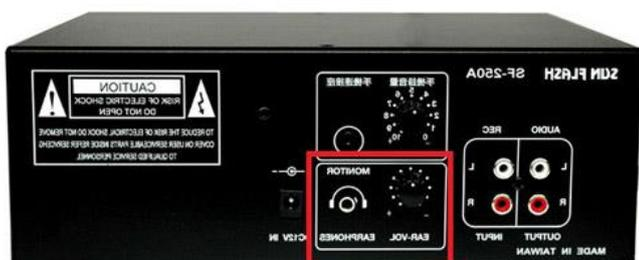
4. 接手機錄影或錄音介面 - 用機器附的這條音源線，一頭插在機器的插孔，另一頭插在手機的耳機孔手機錄音量的旋鈕放在預設 "5" 的位置
